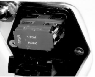
图 19– 保险丝更换方向，显示的是 115V 的方向
