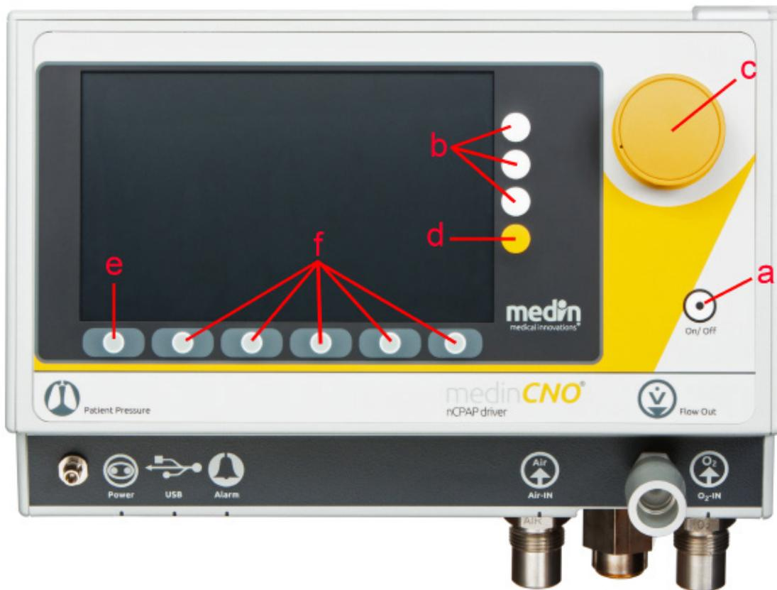
插图 5-1: medinCNO<sup>®</sup> 的按键: a) **ON/OFF**; b) 用于设置基本 CPAP 特征参数的按键; c) 用于修改和确认设置值的旋钮; d) 手动推送触发按钮; e) 警报复位按钮; f) 用于模式专属和其他设置的按钮
